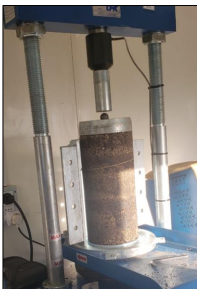
Figura 9. Ensayo triaxial sin confinamiento
