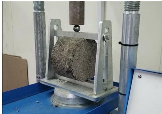
Figura 8. Ensayo de resistencia a la tracción indirecta
