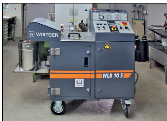
Figura 7. Unidad de espumado de laboratorio [4]
